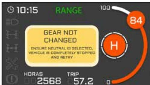
Al cambiar de marcha, este mensaje aparecerá si este proceso no se ha realizado correctamente. Siempre hay que cambiar la marcha parando en el N.
