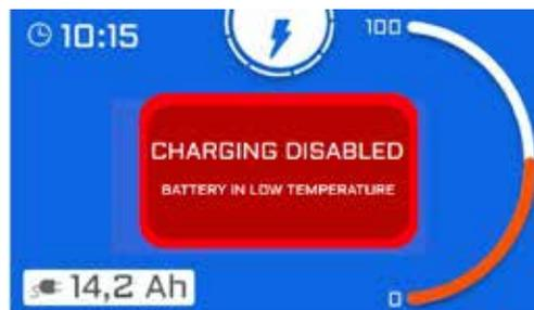
Durante la carga puede aparecer la siguiente notificación. Si esto sucede el vehículo no se podrá cargar hasta que la temperatura del conjunto de batería haya aumentado.
