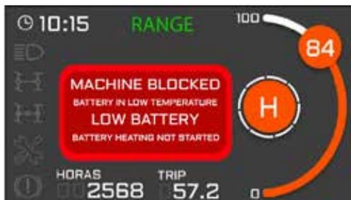
Si al activar el calentador la batería está muy baja de carga aparecerá este mensaje.
