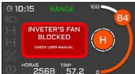
Si este mensaje aparece se debe de revisar la zona del inversor, puede haber algún elemento que no permite el correcto funcionamiento de los ventiladores o suciedad en la zona. Si este no es el caso contacte con su servicio técnico más cercano.
