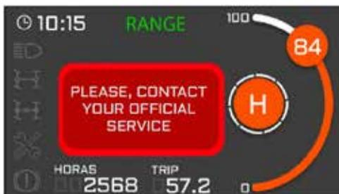
Si se muestra este mensaje en la pantalla, el vehículo se encuentra en un fallo de invertir o batería. No funcionará y se debe de contactar al servicio técnico.
