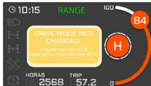
Ao alterar o modo de condução durante o funcionamento, aparecerá a seguinte notificação. Pare o veículo e tente novamente.
