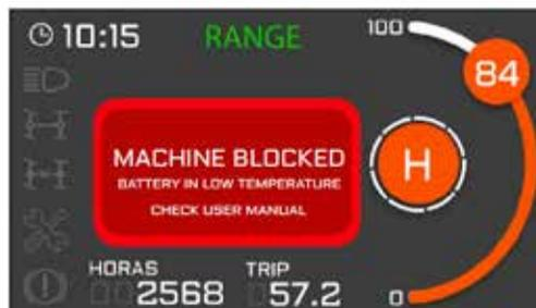
Quando a bateria está a ser utilizada e a temperatura da bateria é inferior à temperatura de funcionamento (-14 °C), estas mensagens aparecerão no visor, dependendo se dispõe do aquecedor da bateria ou se não. Caso não disponha dele, será impossível utilizar o veículo até que a temperatura aumente. Nos veículos equipados com um aquecedor, deve aguardar-se com a chave em "ON" até que a temperatura correta seja atingida.
