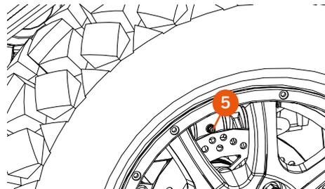
**!** É necessário lubrificar os pontos indicados, conforme estabelecido na tabela de manutenção, para evitar o rápido desgaste dos componentes.
