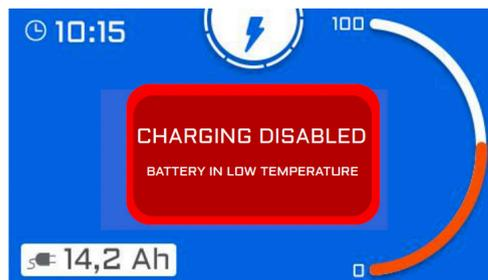
Cette notification peut s'afficher pendant la recharge. Le cas échéant, le véhicule ne peut être rechargé qu'à partir du moment où la température du bloc-batterie a augmenté.
