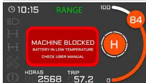
Cuando la batería esté en uso y la temperatura de esta se encuentre por debajo de la temperatura de funcionamiento (-14°C), aparecerá en pantalla estos mensajes dependiendo si dispone de calentador de batería. En caso de no tenerlo será imposible utilizar el vehículo hasta que aumente la temperatura. Para los vehículos que disponen de calentador, se debe de esperar con la llave en ON hasta que alcance la temperatura correcta.
